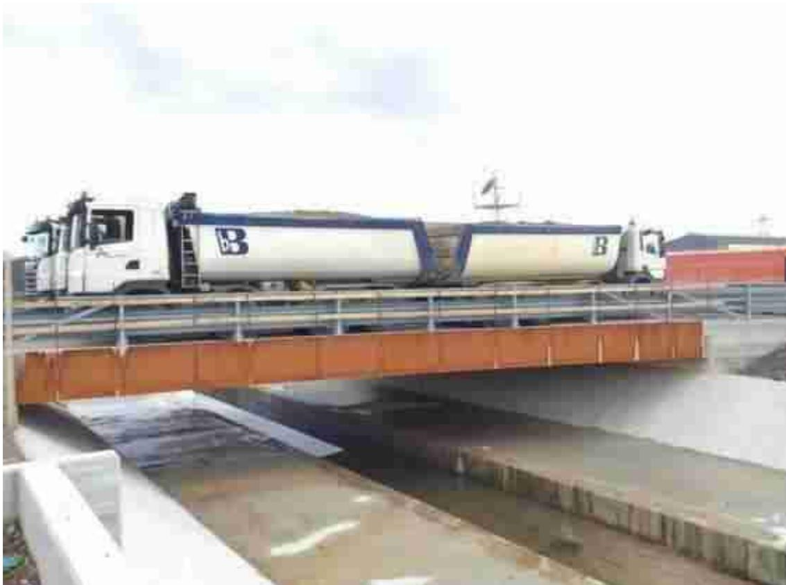
*Figura 124: Prova di collaudo.*
