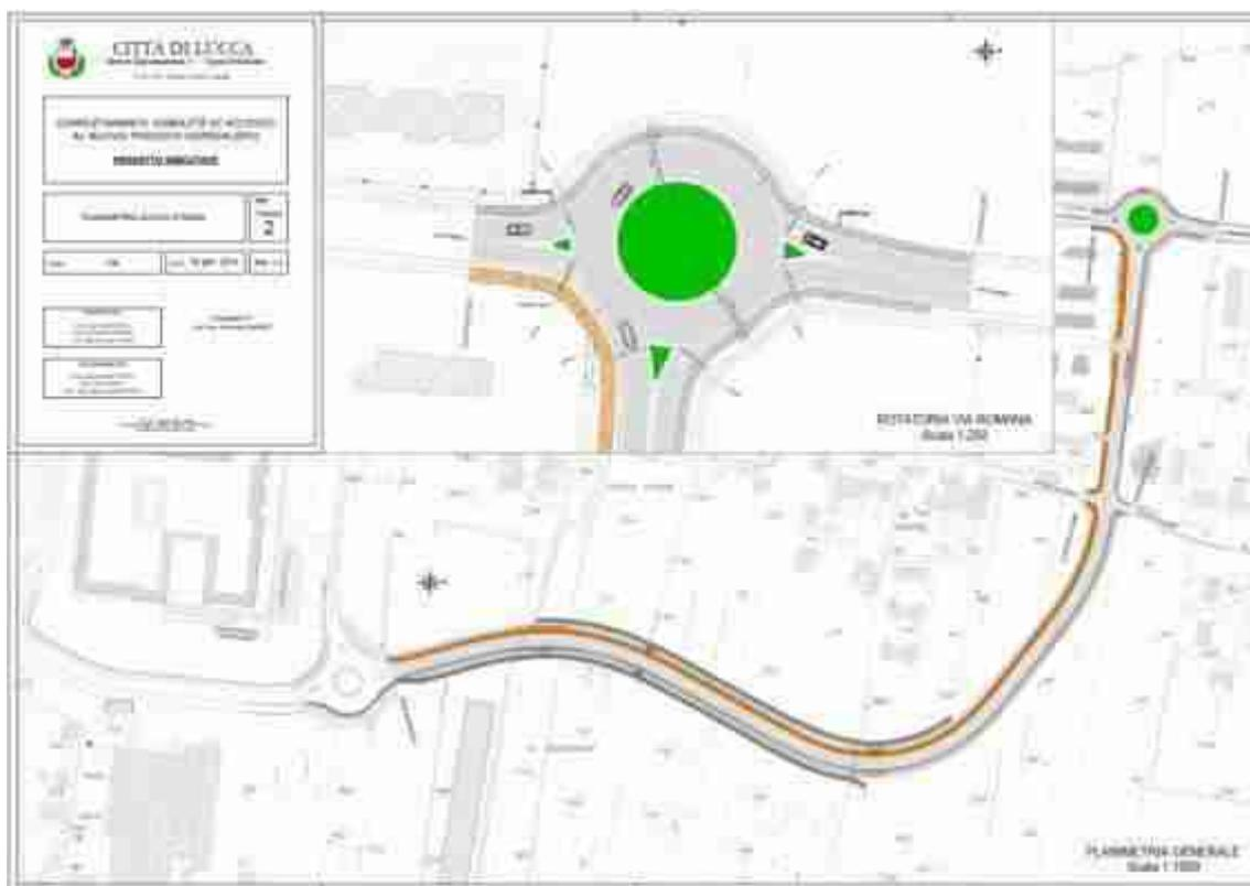
Figura 126: Planimetria della strada di progetto e rotatoria su Via Romana.
